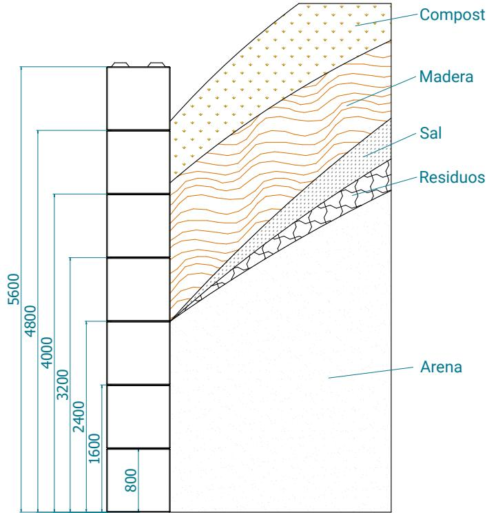
Ejemplo de colocación del bloque de hormigón en formación de muro barrera para el acopio de materias primas a granel.
